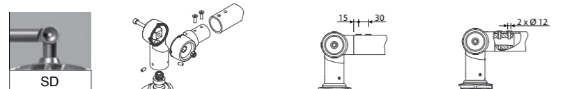
Couple de serrage (Torque / Drehmoment) : 25 N.m Fix. sommitale par rotule pénétrante pour tube Ø 60 mm FR Male suspended knuckle-joint for Konus and Ø 60 mm tube EN Hängend durchdringend Gelenk für Rohr Ø 60 mm DE
